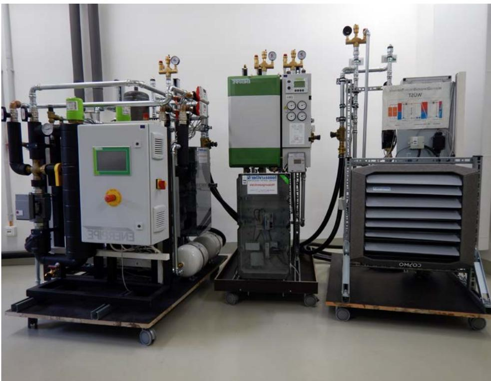
Versuchsstand für Fernwärmevergäbestationen: Im Forschungsvorhaben Smart Heat Grid Hamburg soll eine intelligente Infrastruktur in das Wärmenetz Hamburg-Wilhelmsburg integriert werden.
