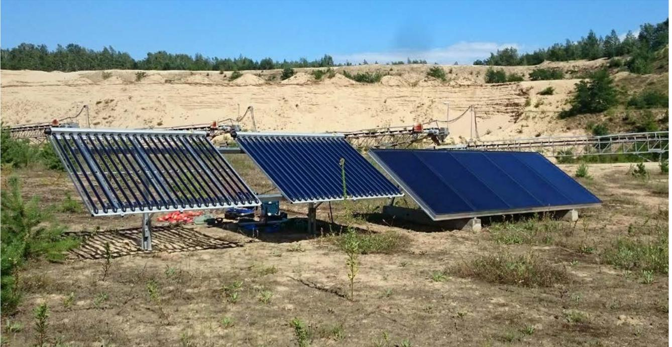
Wie Solarthermie in die Dresdner Fernwärmeversorgung integriert werden kann, untersucht ein Forscherteam in Green Heat<sup>3</sup>: Diese Versuchsanlage mit verschiedenen Solarthermiekollektortypen soll den Einfluss auf die Entwicklung des Bodens und der Pflanzen prüfen.
