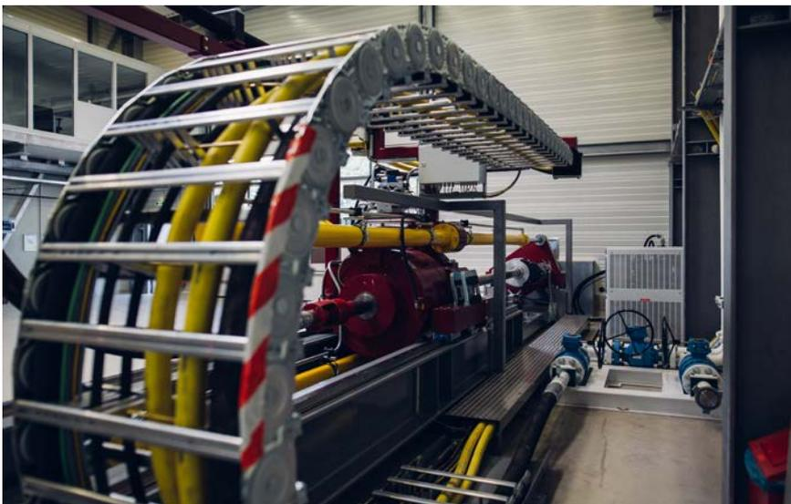
Die Tests für das Projekt OBS werden mit einer waagrecht montierten Bohranlage durchgeführt. Der Antrieb (rot, mittig im Bild) treibt das Bohrgestänge an, das aus der Halle heraus auf das Gelände ragt.
