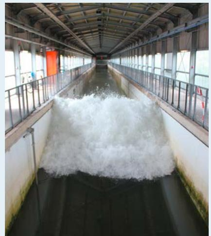
Im großen Wellenkanal in Hannover werden Bauteile getestet, die bei Offshore-Windenergieanlagen und im Deichbau zum Einsatz kommen.
